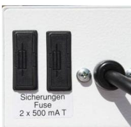
I due fusibili dell'agitatore rotante si trovano in un cassetto al di sotto della spina dell'apparecchio. Per verificare e sostituire questi fusibili è possibile estrarre il cassetto agendo sulle leve di arresto su entrambi i lati. I fusibili potranno essere sostituiti solamente con altri con pari caratteristiche. Le informazioni sul tipo di fusibile impiegato sono riportate sulla targhetta accanto alla presa dell'apparecchio e negli schemi elettrici.
